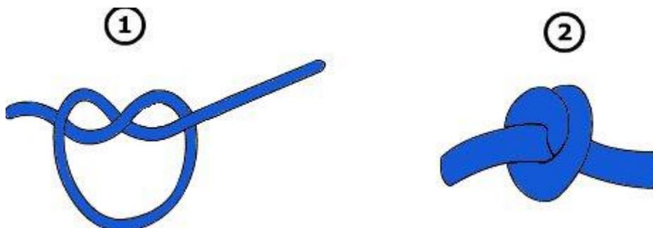
**Nœud en huit** : empêche une manœuvre de se dépasser où arrête l'extrémité d'un cordage. (Employé à la voile aux extrémités des écoutes).
