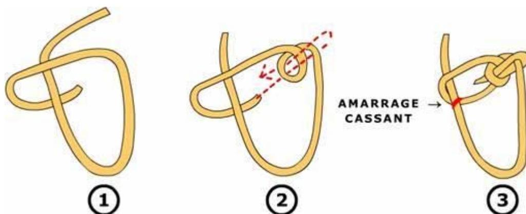
**Nœud de bouline** : Employé pour étalinguer un câble. Egalement pour couler un maillon .Il est préféré au nœud de laguis coulant si le cordage utilisé est de gros diamètre.
