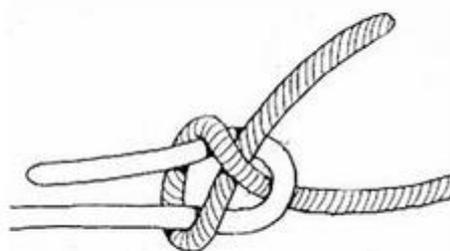
**Nœud d'écoute double** : sert à réunir deux cordages de même ou de différents diamètres, dont l'un est terminé par un œil. (Former l'œil avec le cordage le plus gros s'ils sont de diamètres différents).
